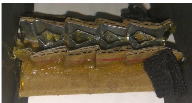
Рис. 9.19. Обрамление 3D модели из алюминиевой фольги по форме модели элемента в обрамлении из картона.
